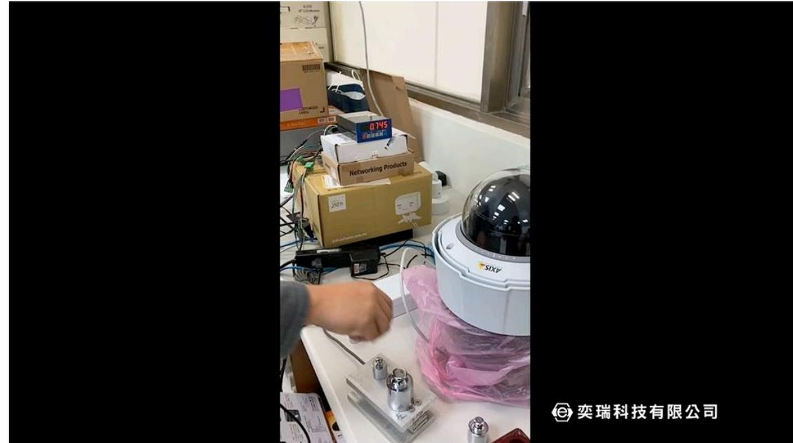
由手機拍攝儀表上傳雲端主機，辨識主機再回傳結果，且User可以調整數值
